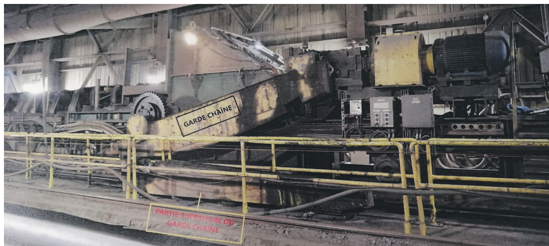
Sur la photo, on peut voir le garde chaîne. Des employés ont témoigné qu'on entendait un bruit de claquement s'amplifier, dans les jours précédents l'accident du 7 juin 2019. Photo déposée en preuve lors du procès
